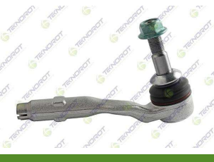
B-901 Steering Tie Rod End Rotbaşı Front Right Ön Sağ 32106784796 B=M14 x 1,5 H=M14 x 1,5 W=0,677
